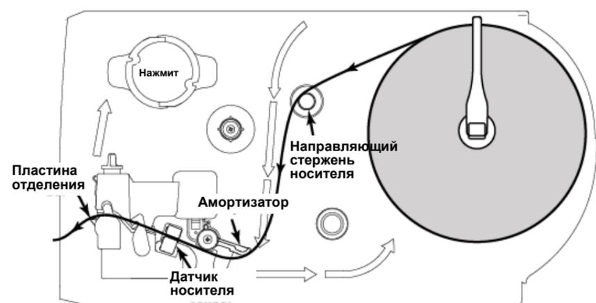
**(7)** С помощью передней панели с дисплеем задайте тип датчика носителя и откалибруйте выбранный датчик. (См. «Калибровка датчика носителя» в правой части этой страницы.)
